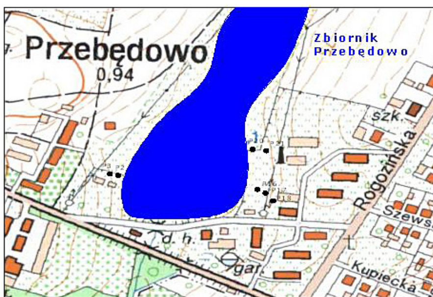
Rys. 3. Lokalizacja studzienek do pomiaru stanów wód gruntowych w terenie przyległym do zbiornika
