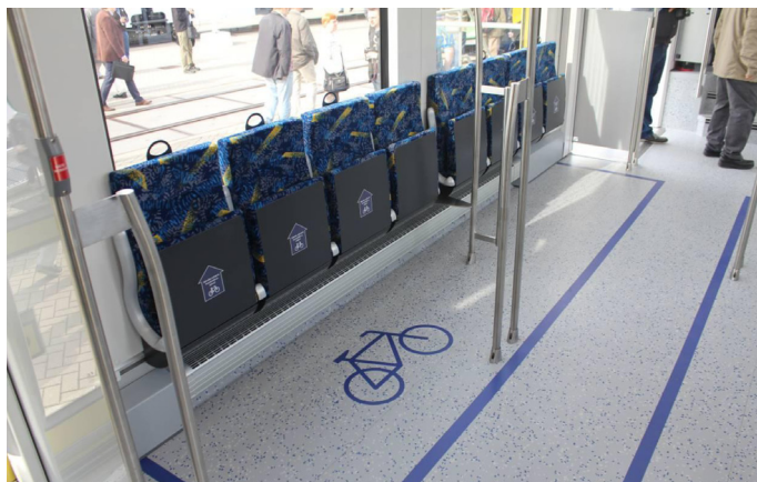
Fot. 11. Wydzielenie na posadzce wagonu przestrzeni, którą mogą zajmować rowery (Vlexx), na fotelach znajdują się nalepki informacyjne o konieczności przytwierdzenia rowerów za pomocą pasów bezpieczeństwa. Fot. Michał Beim
