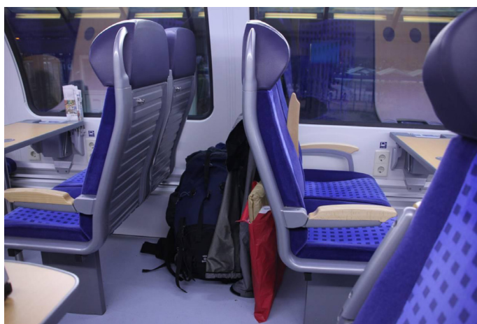
Fot. 14. Wykorzystanie przestrzeni między tyłami foteli na przewóz bagażu w pociągu piętrowym (pociąg Bombardier Dosto dla DB Regio). Fot. Michał Beim
