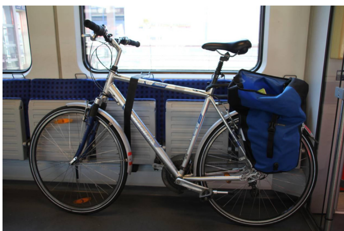
Fot. 8. Pas bezpieczeństwa do przytwierdzania rowerów w przestrzeni wielofunkcyjnej pociągu aglomeracyjnego. Fot. Michał Beim
