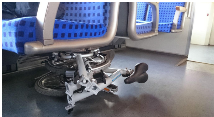
Fot. 13. Odpowiednie zaprojektowanie siedzeń (podwieszanych do bocznych ścian pociągów) umożliwia przewóz sakw i innych bagaży oraz rowerów składanych pod fotelami (pociąg Stadler GTW dla DB Regio). Fot. Michał Beim
