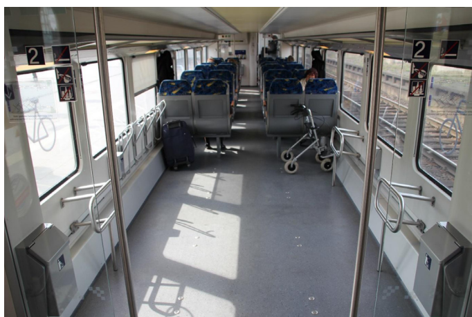
Fot. 7. Przestrzeń do przewozu rowerów w pociągu regionalnym Metronom, która została wyposażona nie tylko w stelaże do opierania rowerów równoległe do ścian pociągu, ale również w stelaże umożliwiające ustawienie rowerów „w jodełkę” (tj. ukośnie do osi pociągu), przy niewielkim wysiłku związanym z koniecznością podniesienia przedniego koła na wysokość ok. 30 cm. Fot. Michał Beim
