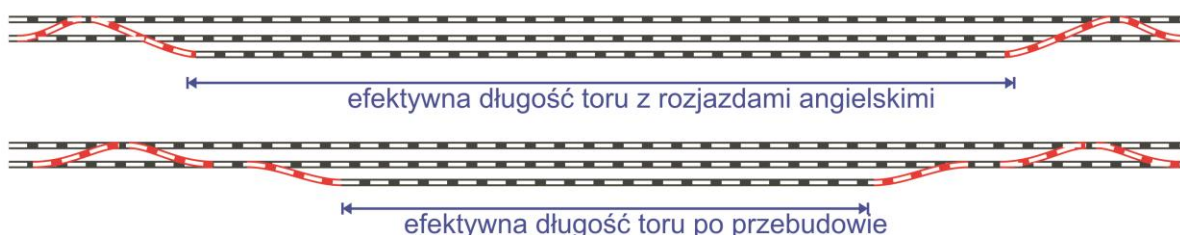
Ryc. 4.9. Utrudnienie prowadzenia ruchu towarowego wskutek przebudowy stacji przede wszystkim z myślą o potrzebach ruchu pasażerskiego (priorytet prędkości)
