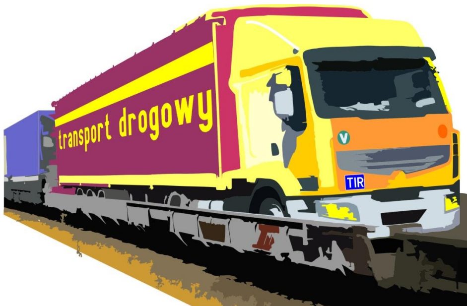
Ryc. 7.5. Wagon niskopodwoziowy do przewozu kompletnych zestawów drogowych
