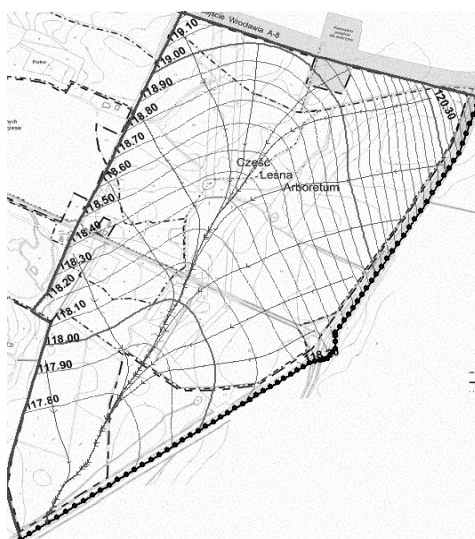
Rys. 1. Obliczone hydrozohipsy i kierunki spływu wód gruntowych na koniec listopada 2004 r.
