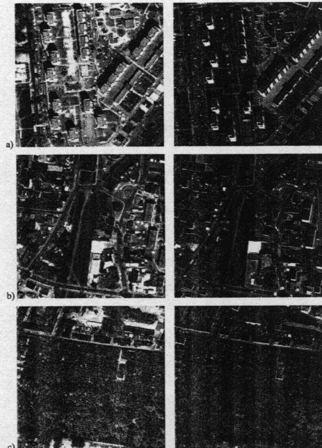
Rys. 7. Porównanie wyostżonych kompozycji barwnych (kanały widzialne) obrazów QB-2 i WV-2 wybranych typów obszarów miejskich: a) osiedle mieszkaniowe, b) węzeł drogowo-kolejowy z zabudową niską, c) ogrody działkowe i cmentarz (opracowanie własne)
