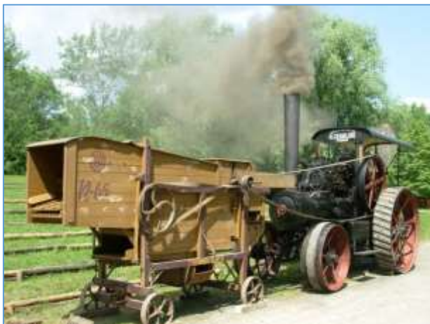
Rys. 8. Lokomobila parowa H. Cegielskiego o mocy 35-40 KM z 1919 r. w Muzeum ( http://www.muzeum-szreniawa.pl/imuzeum/web/app.php/vortal/ ), Fot. K. Bamber
